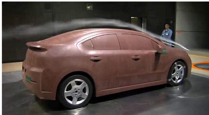
Slika 2.7. Prototip od gline za potvrđivanje načela, razvijen za potrebe testiranja predloženog dizajna automobila s ciljem unaprijeđenja vrijednosti koeficijenta otpora zraka [5]
