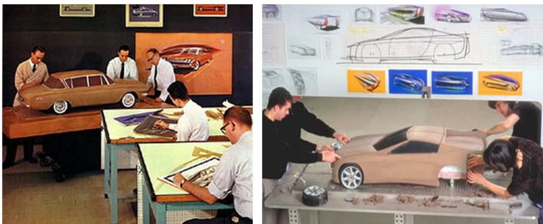
Slika 2.3. Proizvodnja fizičkog prototipa automobila u glini: 1961. godine American Motors Corporation- AMC (desno) [2], moderni razvojni studio (lijevo) [3]
